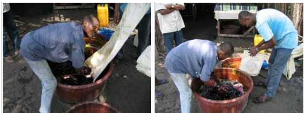
Le batikié doit se protéger les mains avec des gants en caoutchouc.
